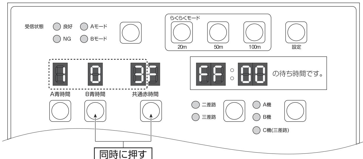
上部の点線内に数字(バージョンNo.)が表示されます
