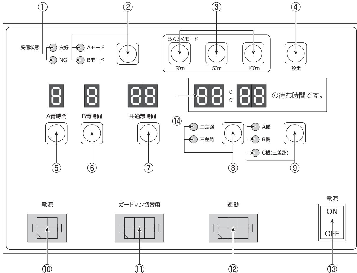
①受信状態表示ランプ …GPSの受信状態をランプにて表示します
